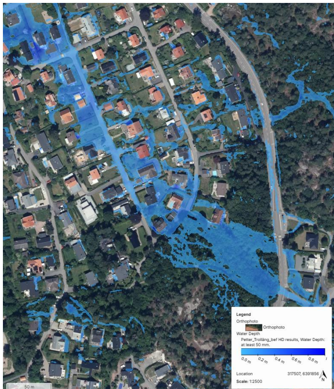
Figur 70. Beräknat maximalt vattendjup vid skyfall (klimatkompenserat 50-årsregn), befintlig situation, beräkning med "Scalgomodellen" (Bild: Scalgo)
