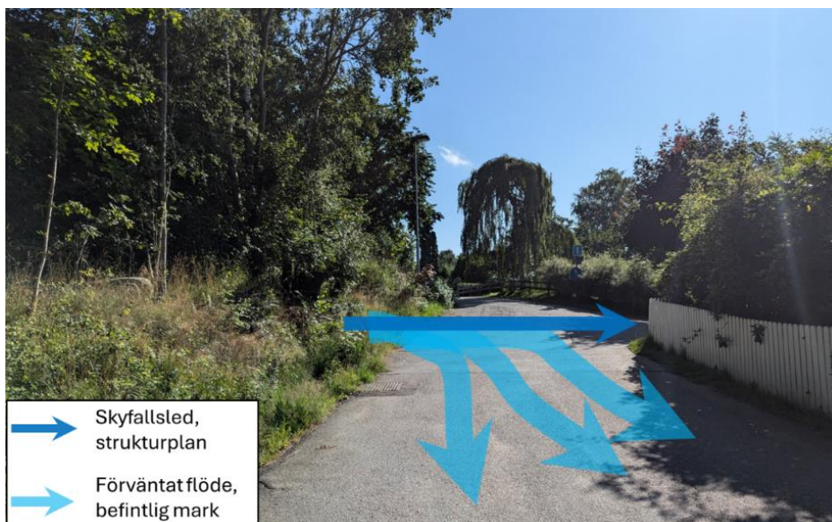
Figur 46. Ögårdesvägen. Skyfallsled enligt strukturplan samt förväntat skyfallsflöde med befintlig mark. Till vänster: område där radhus planeras inom detaljplan (Foto: Petter Mogenfelt).
