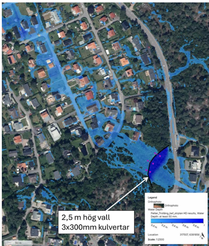
Figur 71. Beräknat maximalt vattendjup vid skyfall (klimatkompenserat 50-årsregn), befintlig situation med vall för skyfallshantering, beräkning med "Scalgomodellen" (Bild: Scalgo)
