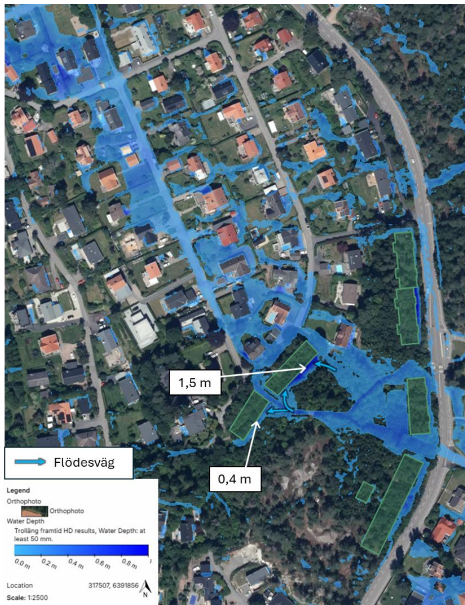
Figur 42. Beräknat maximalt vattendjup vid skyfall, klimatkompenserat 50-årsregn, framtida situation inom PEAB:s mark. Blåa pilar visar flödesvägar mot planerade radhus. Vita pilar visar läge för maximalt modellerat vattendjup mot fasader (Bild: Scalgo)
